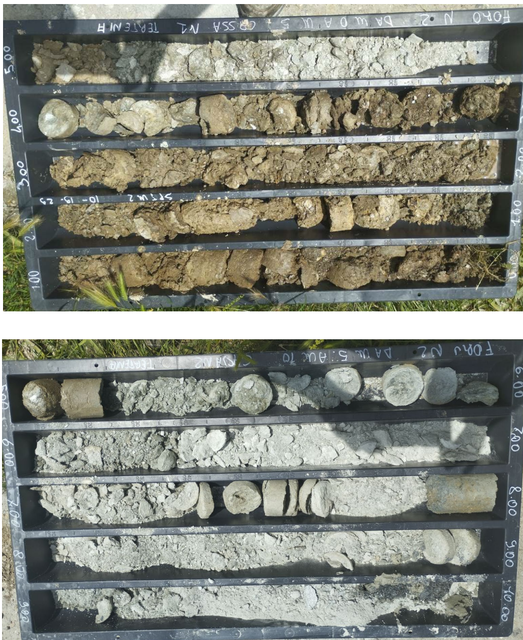
Figura 6 – Stratigrafie riscontrate nel Sondaggio S 2
