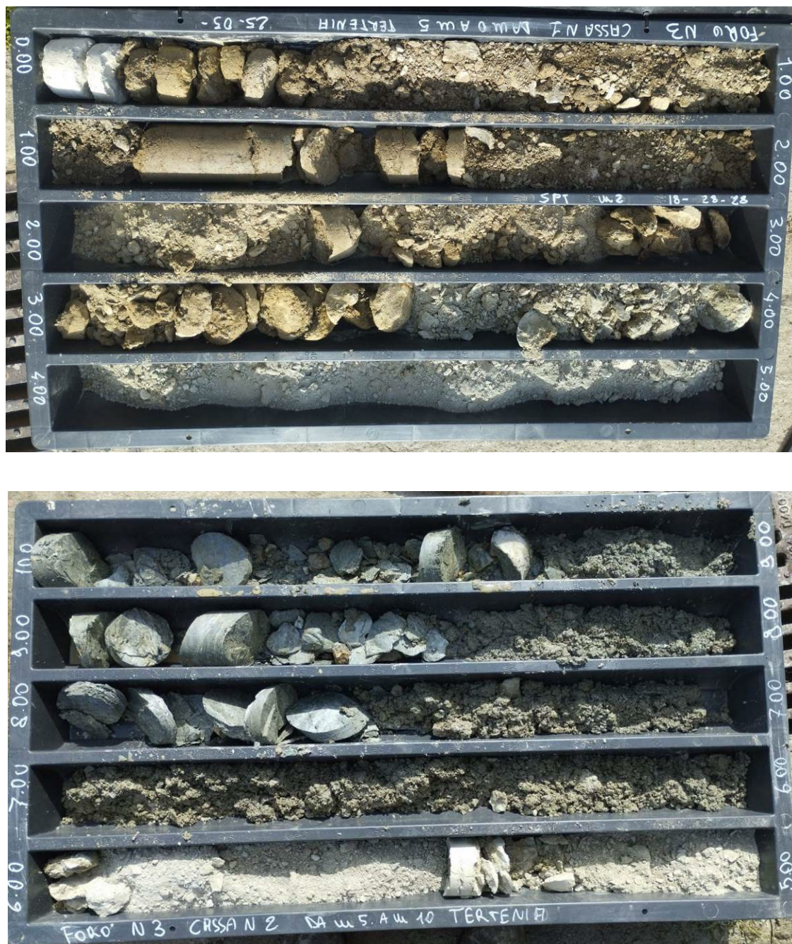
Figura 8 – Stratigrafie riscontrate nel sondaggio S 3
